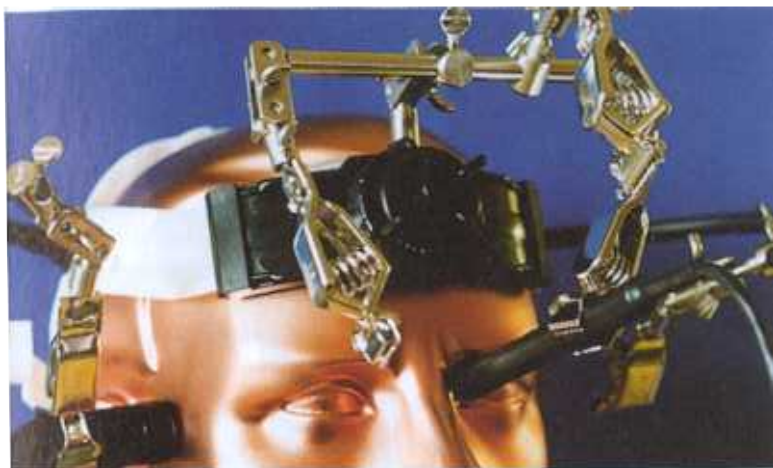
Der „Grazer Helm“ misst die Durchblutung von Auge und Gehirn
